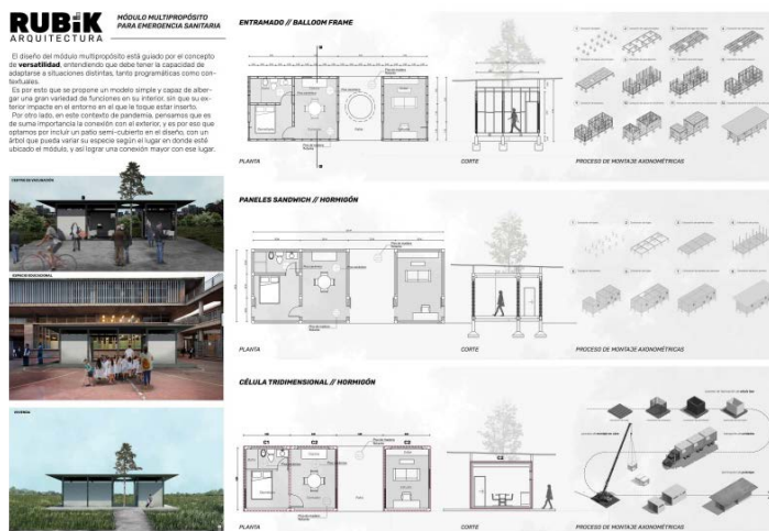
Figura 1. Panel síntesis realizado al final del cursado donde se observan los distintos sistemas constructivos. Fuente: De Mendiburu, Corrales, Fernández, Polo y Ríos Mellone.
