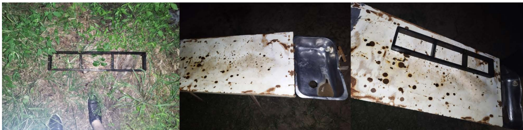
Figura 2. Herramientas artesanales utilizadas para realizar ladrillos de adobe. Fuente: fotografías propias, 2025.
