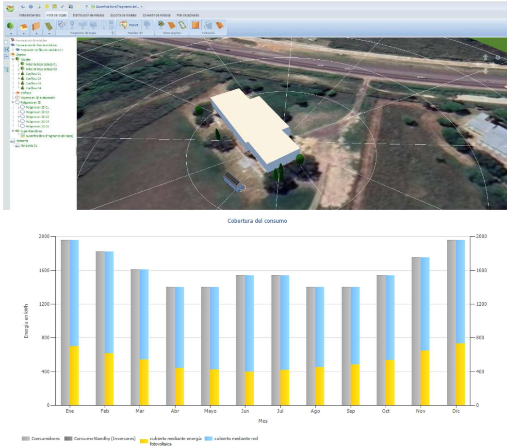
Figura 2: Simulación de Rendimiento del Sistema FV en Software PVSOL. Fuente: Elaboración Propia
